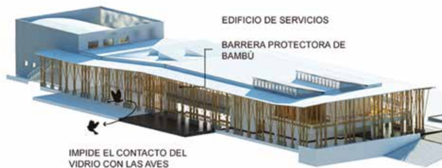
FIGURA 7. MUESTRA LA PIEL DE BAMBÚ CONSTRUIDA ALREDEDOR DEL EDIFICIO PRINCIPAL PARA EVITAR LA COLISIÓN DE LAS AVES CON LOS CRISTALES Y COBIJAR A LOS TURISTAS.
