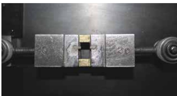
FIGURA 5. Fractura del espécimen (velocidad de 0.5 mm/min).
