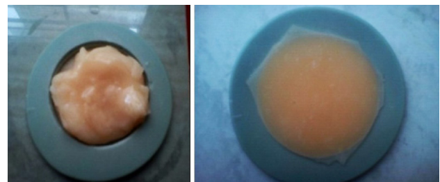
Figura 5. Matriz de silicona con la masa de acrílico.
