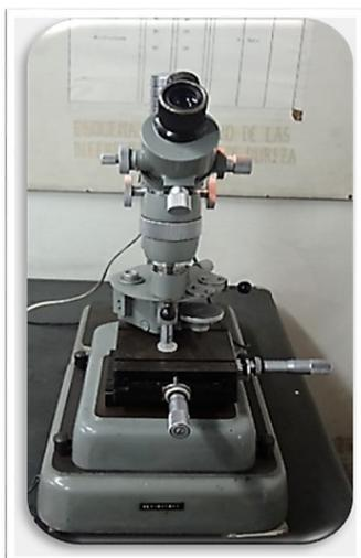
Figura 9. Microdurómetro Leitz Durimet.
